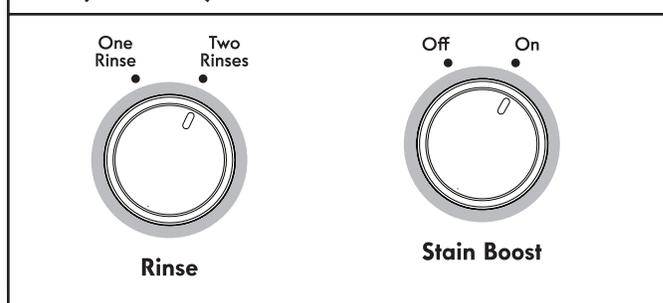
Si l'on souhaite ajouter un Two Rinses (deuxième rinçage) et/ou utiliser l'option STAINBOOST (puissance anti-taches), tourner le bouton correspondant à cette caractéristique.
