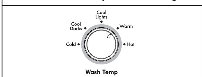
Après avoir sélectionné un programme, sélectionner la température de lavage en tournant le bouton Wash Temp au réglage souhaité.
