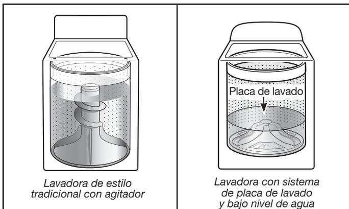
La mayor diferencia en su nueva lavadora es el sistema de placa de lavado y bajo nivel de agua. La lavadora regula automáticamente el nivel del agua de acuerdo al tamaño de la carga; no se necesita un selector de nivel de agua.
