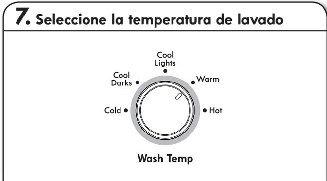
Una vez que haya seleccionado un ciclo, seleccione la temperatura de lavado, girando la perilla de Wash Temp (Temperatura de lavado) hacia el ajuste deseado.
